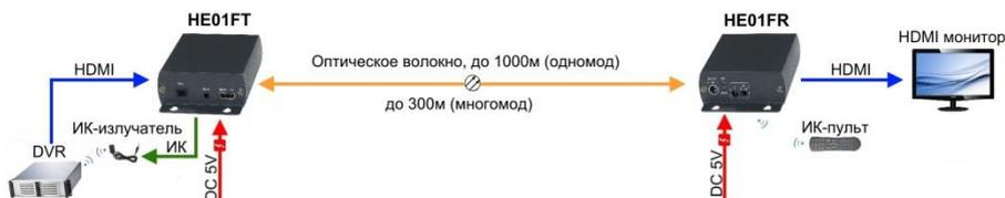
Рис.4 Типовая схема подключения комплекта HE01F
